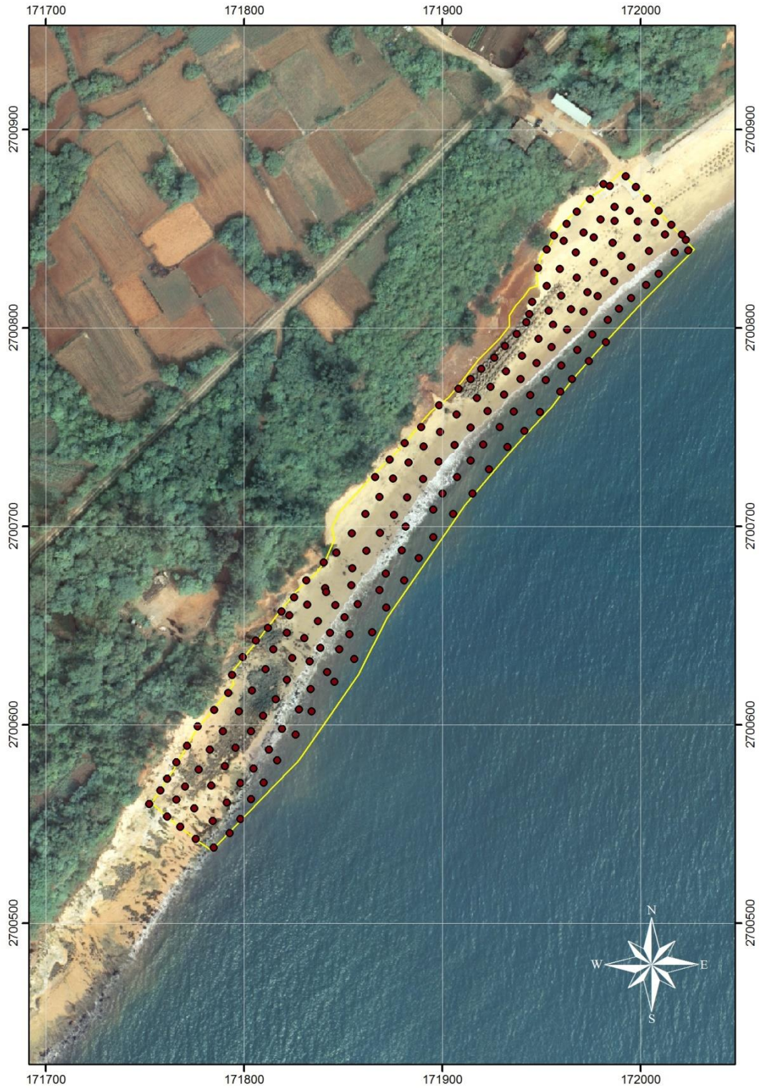
圖 3.4.1.1 烈嶼南山頭海岸 2016 年 10 月 RTK-GPS 測量點位置圖
