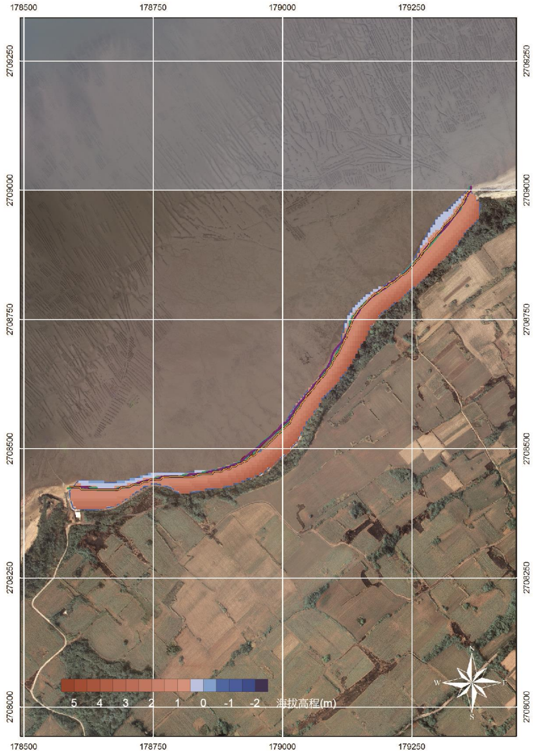
圖 3.4.2.5 北山海堤海岸 2016 年 10 月 5 米數值地形模型成果圖(正高)
