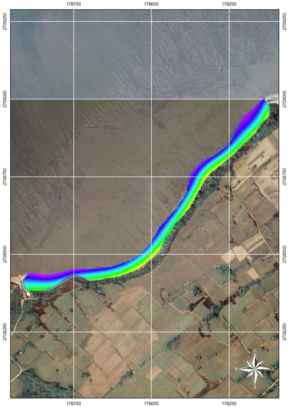
圖 3.4.2.4 北山海堤海岸 2016 年 10 月 5 米數值地形模型成果圖(橢球高)
