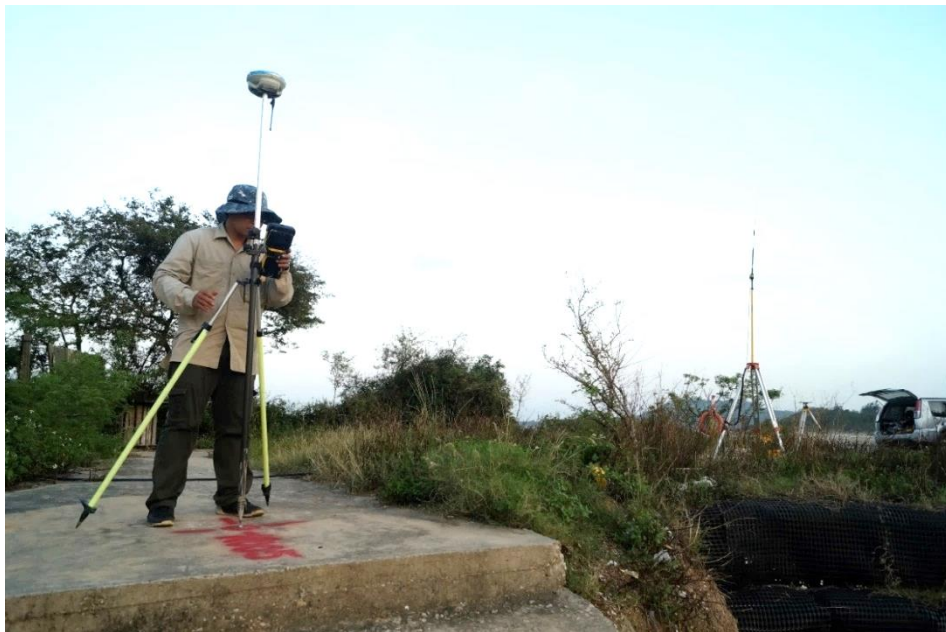
圖 2.1.2.1 即時衛星動態定位(RTK-GPS)測量
