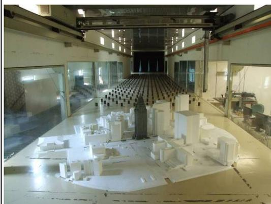
圖 2-15 建築結構風載重試驗
