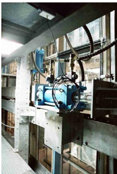
圖 2-5 帷幕牆層間變位測試
