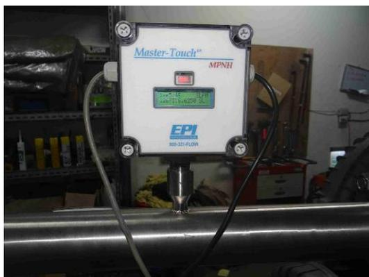
圖 2-2 以空氣流量計量測密閉測試艙之試體漏氣量
