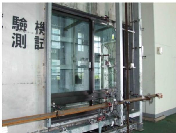
圖 2-4 以位移計記錄試體的變形情形
