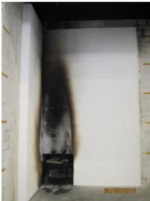
圖 2-24 DIN 4102-20 試驗後外觀[50]
