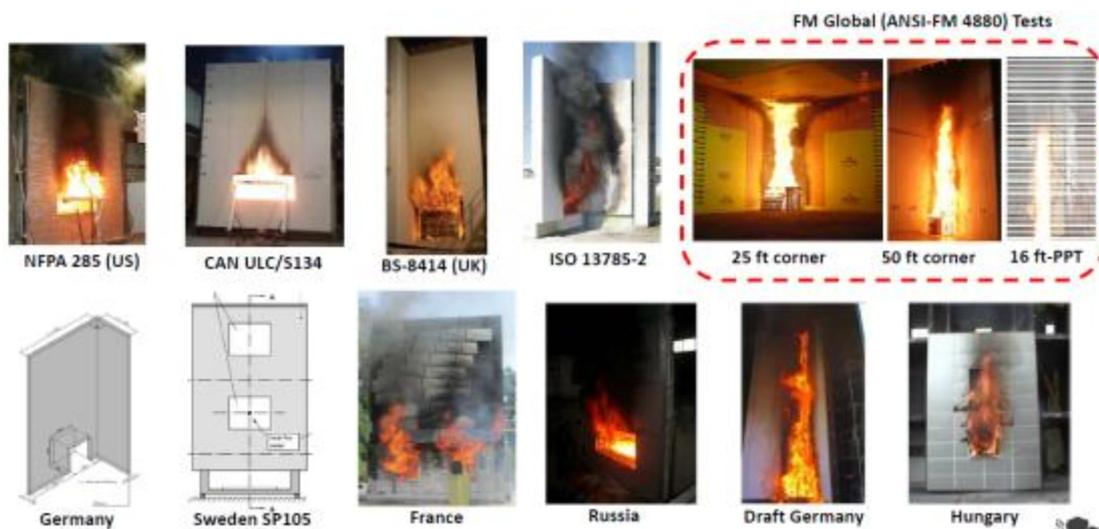
圖 2-28 外牆隔熱系統全尺度防火試驗 [12]
