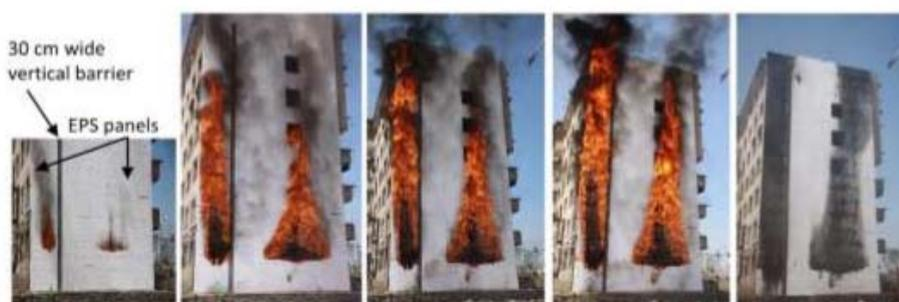
圖 2-11 實尺寸 EPS 外牆延燒試驗
