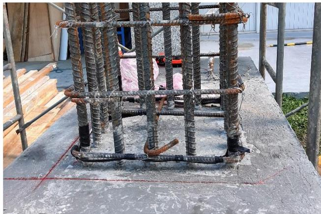
圖 3-4 SND50 試體柱內鋼筋黏貼應變計
