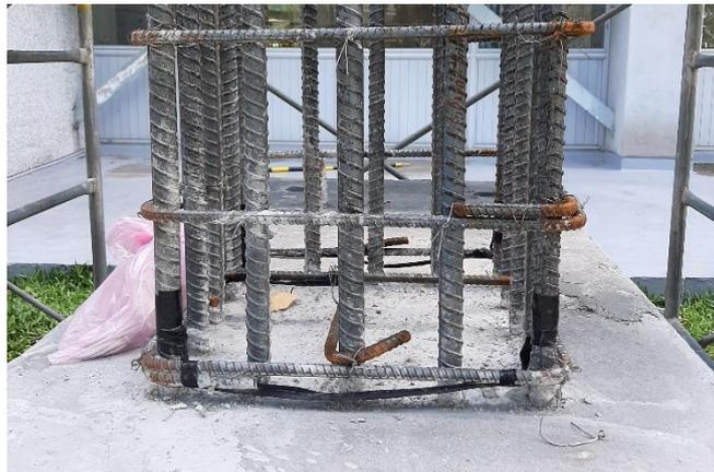
圖 3-6 SND50R06T2 試體柱內鋼筋黏貼應變計
