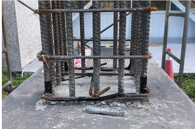
圖 3-5 SND50R06T1 試體柱內鋼筋黏貼應變計
