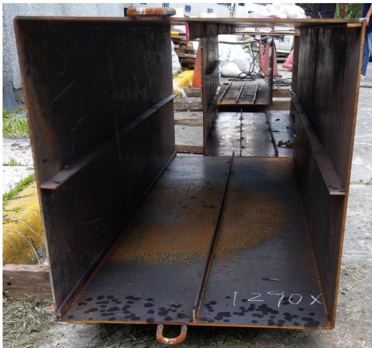
圖 3-11 以 2 個 L 型鋼板組合成乾式補強鋼板
