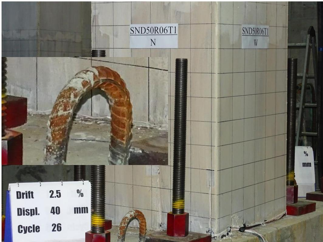
圖 3-22 SND50R06T1 試體基座可看出整塊開裂
