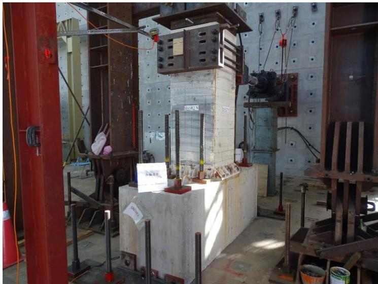
圖 2-10 軸力構架試驗裝置照片
