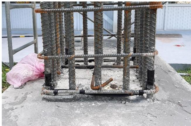
圖 3-7 SND50R10T3 試體柱內鋼筋黏貼應變計
