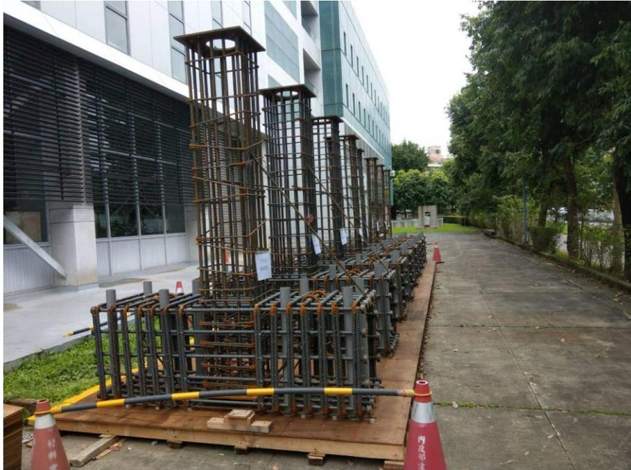
**圖 3-1 試體鋼筋組立(基座及柱)**
