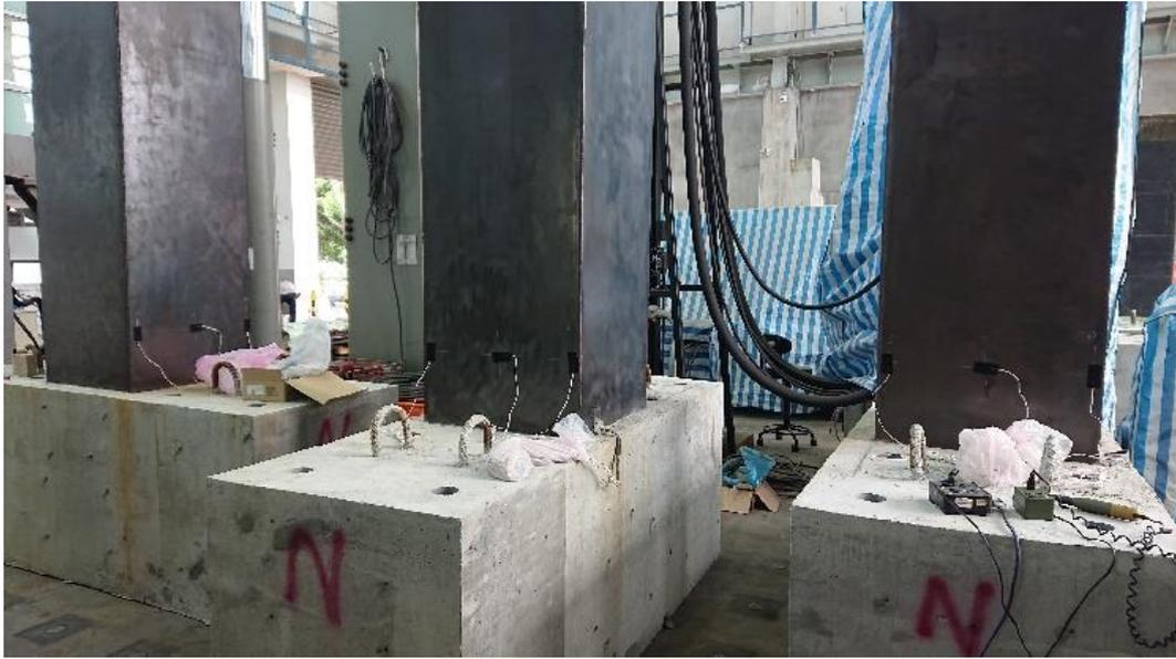
圖 3-12 鋼板補強試體之鋼板表面應變規黏貼
