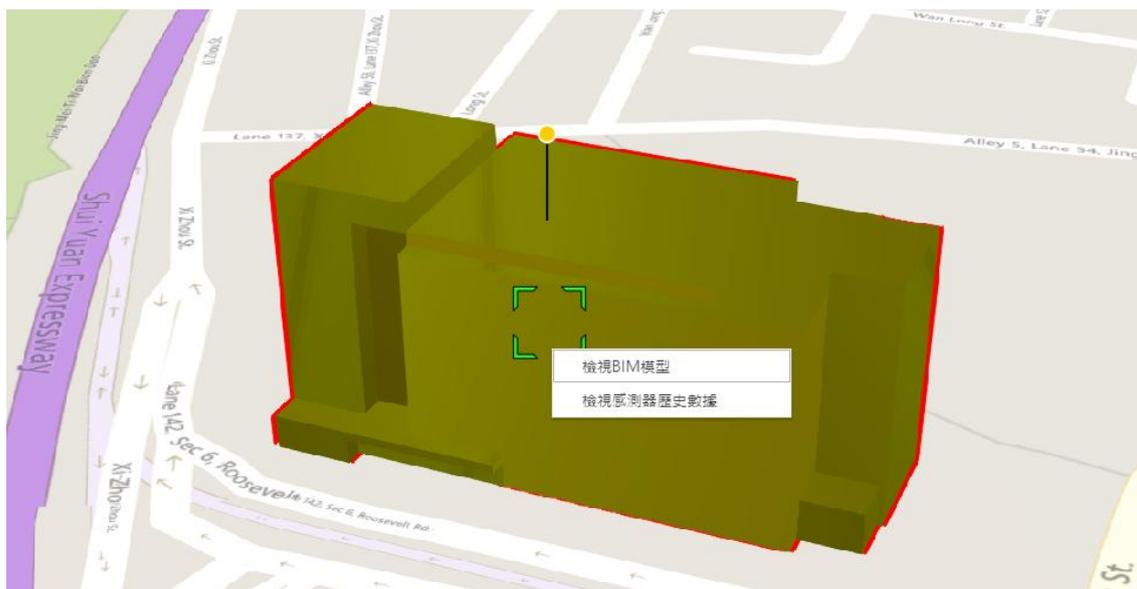
圖 38: 進入到監測頁面點選 GIS 模型右鍵，選擇檢視 BIM 模型。
