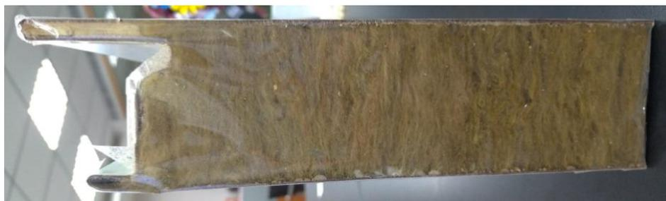
圖 5-5-24 複層式岩棉金屬板實物外型
