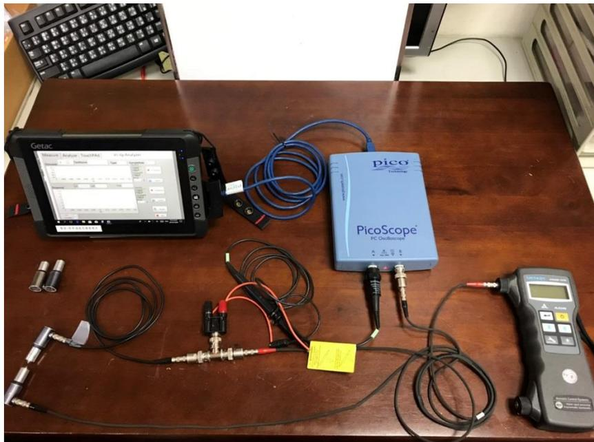
圖 3.15 火害探傷檢測系統軟體整合
