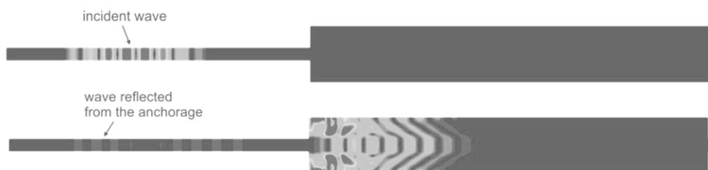
圖 2.32 導波在鋼筋與混凝土包覆段之傳遞情形
