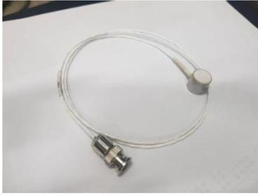
圖 3.10 壓電式感應器
