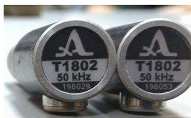
(c) 剪力波探頭 脈衝頻率 50 kHz
