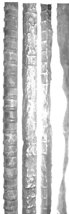
圖 2.21 鋼筋混凝土結構腐蝕過程的漸進階段(Ervin, 2009)
