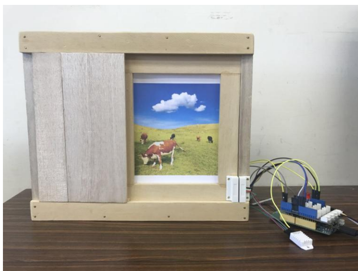
圖 4-11 自製窗戶與雌黃開關、DHT-22 溫濕度傳感器
