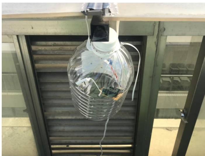
圖 4.7 DHT-22 溫濕度傳感器與粉塵傳感器模組
