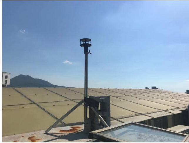
圖 4-4 WindSonic 超聲波風速傳感器架設位置
