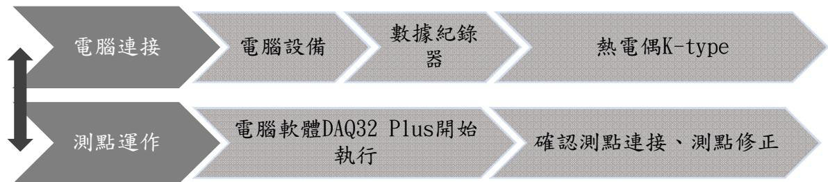
圖 3- 11 溫度儀器設置流程圖
