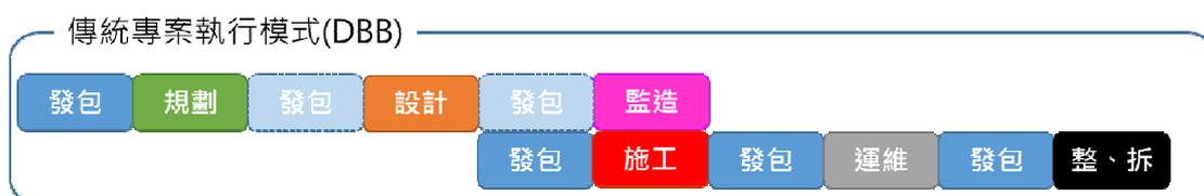
圖 4-4 傳統專案執行模式下不同工作執行流程
