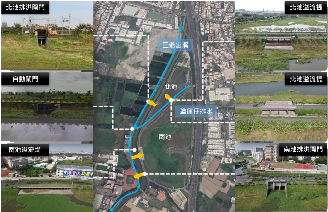
圖 2-14 仁德滯洪池進出口型式流向及現勘照片
