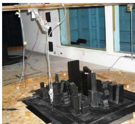
圖 1-12 眼鏡蛇探頭與移動機構配置
