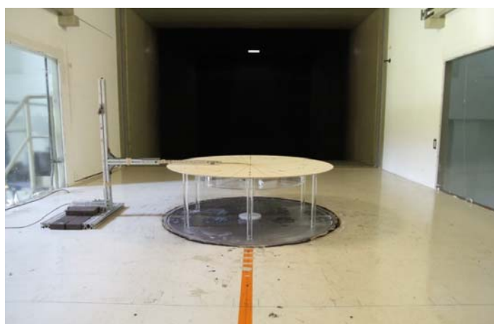
圖2-4 熱線式風速計與地表風速計校正
