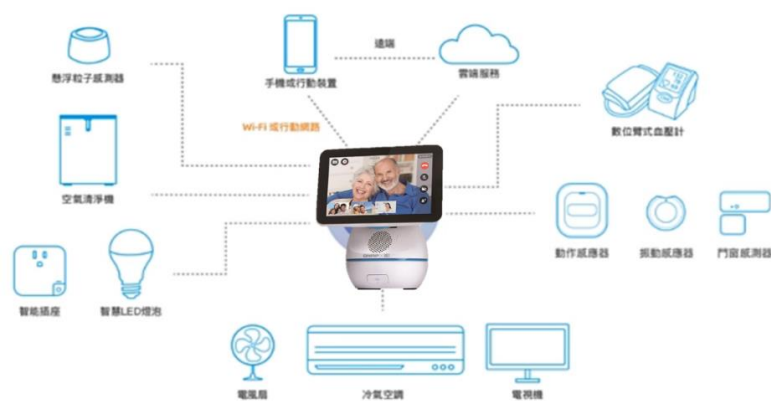
圖2-23 阿福寶以無線方式控制各項智慧化設備
