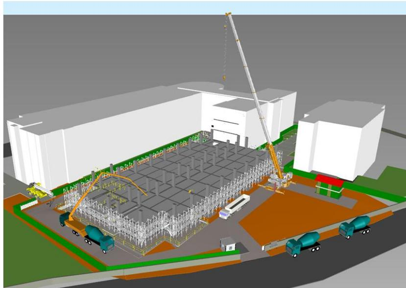
圖 3.33 統包商交付的 BIM 應用「A4 工地利用規劃」說明例
