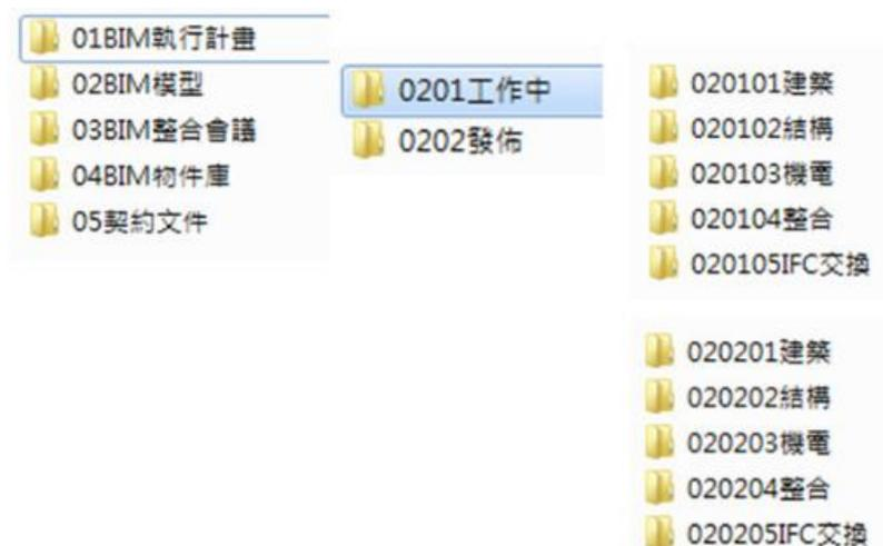
圖1. 國立中央大學總務處 BIM 專案資料夾架構
