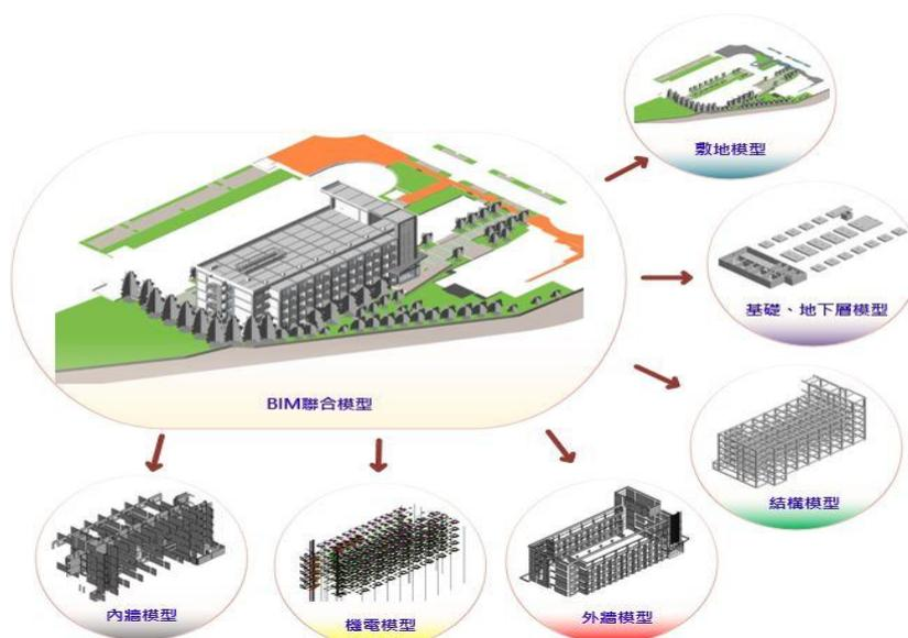
圖2. BIM 模型架構拆分原則
