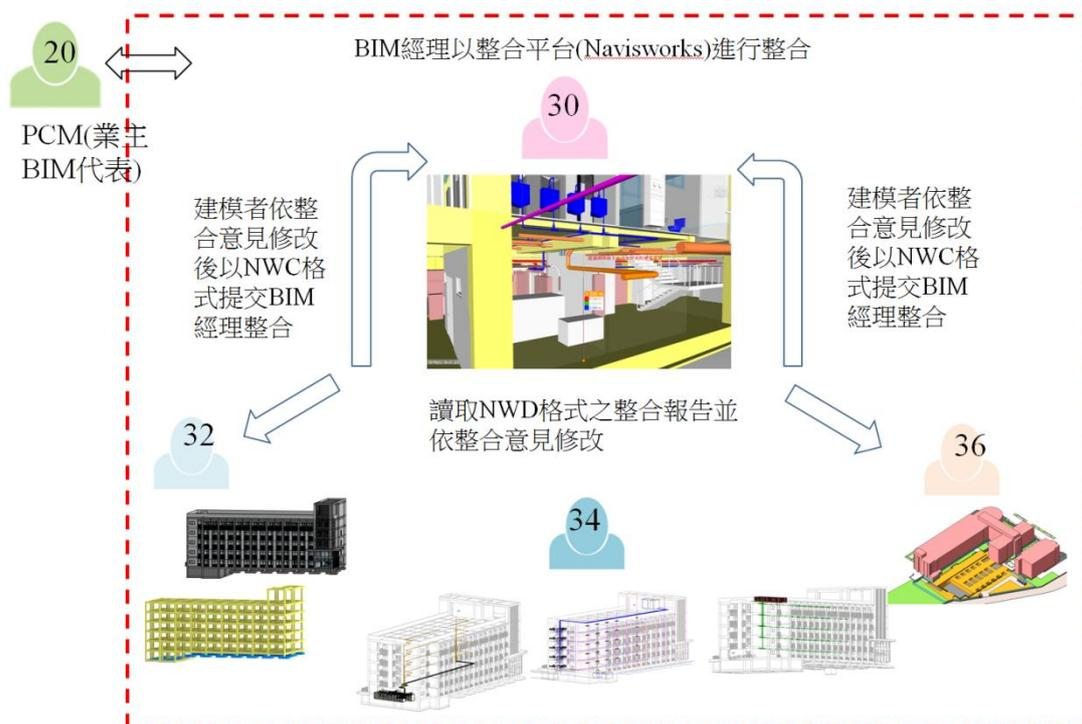
圖 4.6 10601\_DBB 案細設團隊建模檔案責任歸屬及交換流程示意圖
