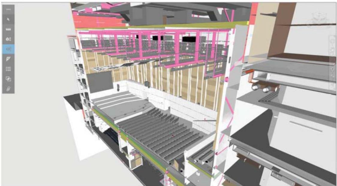
圖 8 整合模型檔案來尋找設計過程中的衝突
