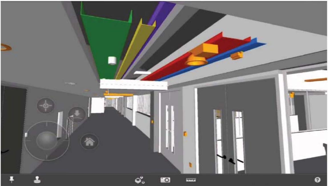
圖 9 模型中顯示未來完工後實際顯示出來的管線模擬
