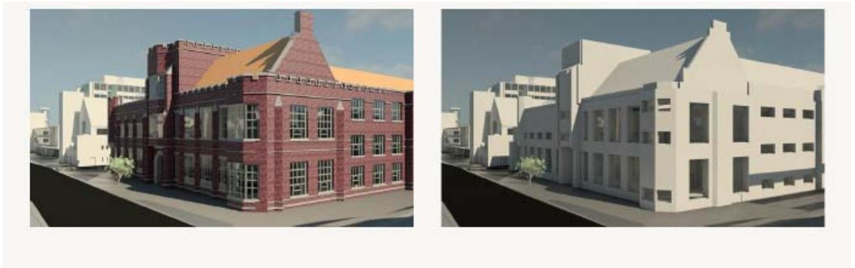
圖 12 依照 AIA 標準繪製的 BIM model 為 LOD 500 (左) 及 LOD 100 (右)
