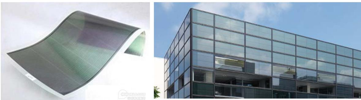
圖 3-6 大成建設 ZEB 實證棟立面使用有機薄膜太陽能板
