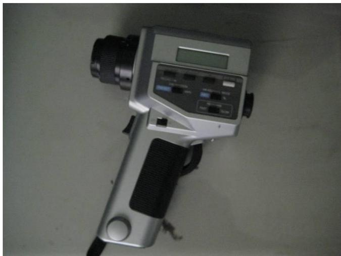
圖 3-2.2 Minolta LS-100 輝度計
