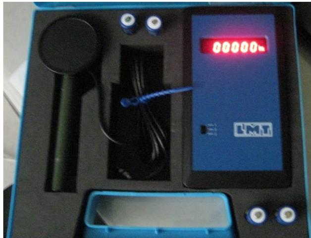
圖 3-2.1 LMT POCKET-Lux 2 照度計
