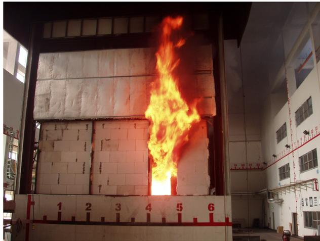
圖 4-28 單開口部挑高空間火災熱釋放率之變化
