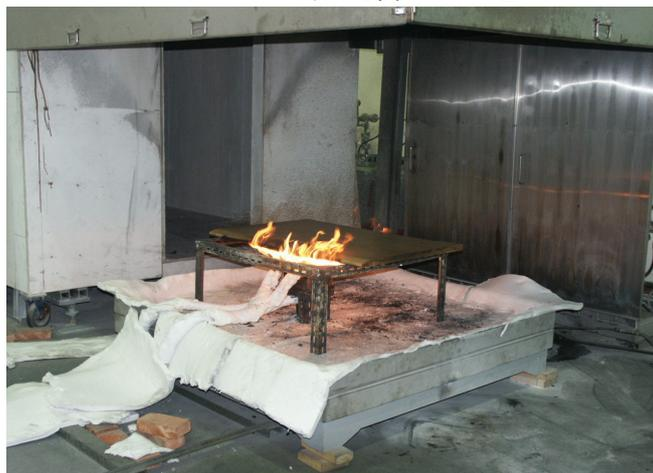
實驗過程中可見起初引火源引燃桌板表面，表材隨之引燃，使熱釋放率略微上升直至表面可燃物被燒盡；隨後桌板不再被引燃，因為表面內部第二層為金屬薄板阻隔熱量的傳遞導致桌板不繼續燃燒。
