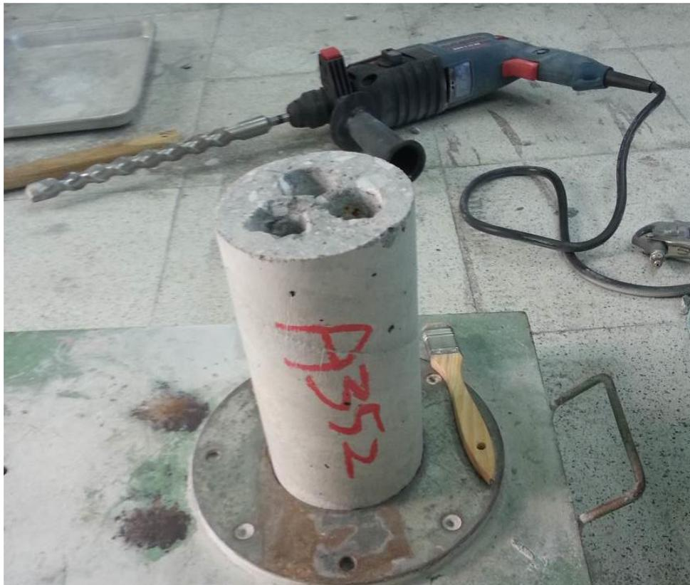
圖 4-2 試體利用普通震動電鑽取樣後情形(直徑 2.5 cm 鑽石鑽頭)
