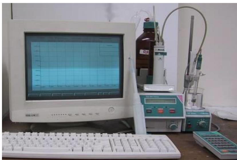
圖 4-8 Metrohm 702 SM 型電位滴定儀
