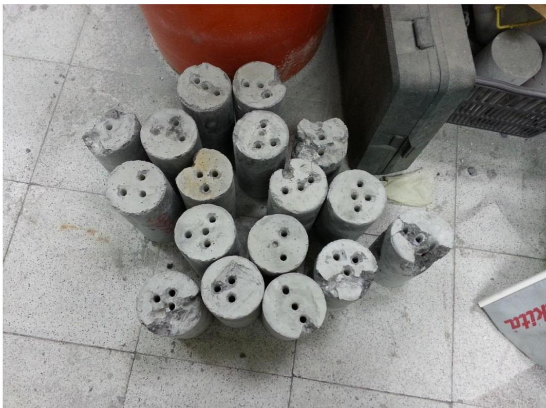
圖 4-3 試體利用普通震動電鑽取樣後情形(直徑 1 cm 鑽石鑽頭)
