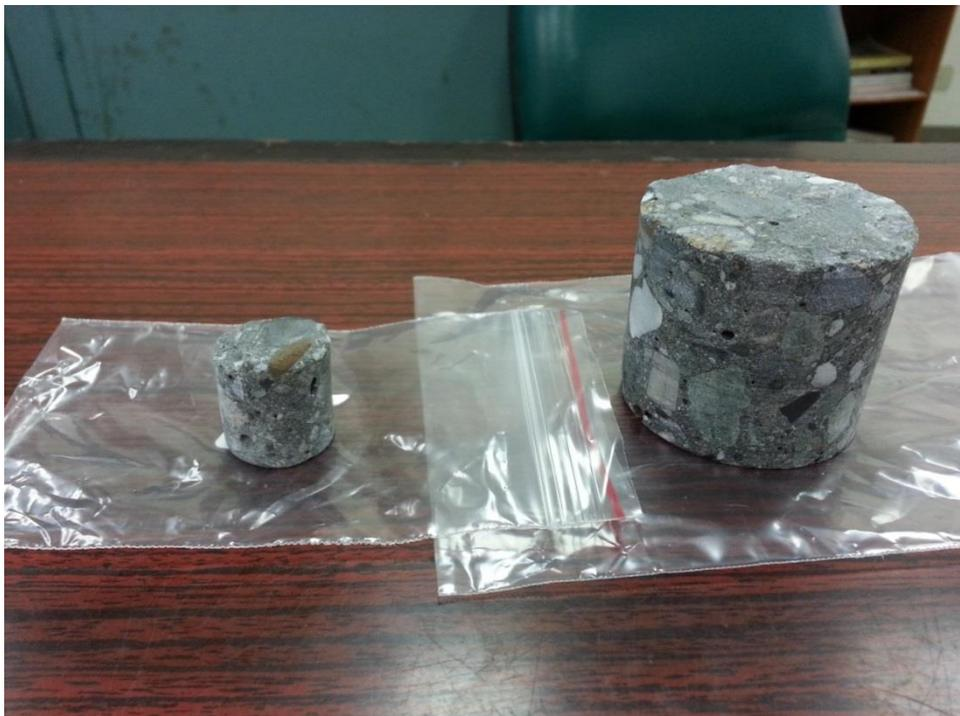
圖 4-5 直徑 2.5 cm 與直徑 5 cm 的鑽心試體
