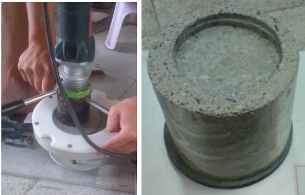
圖 4-1 以磨粉機進行氬離子試樣粉末取樣
