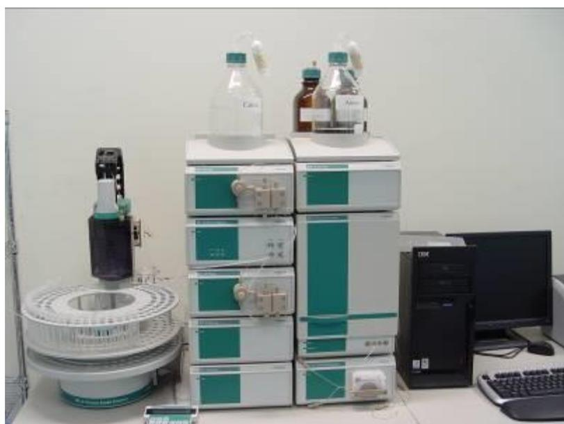
圖 4-11 Metrohm MIC 模組式離子層析儀
