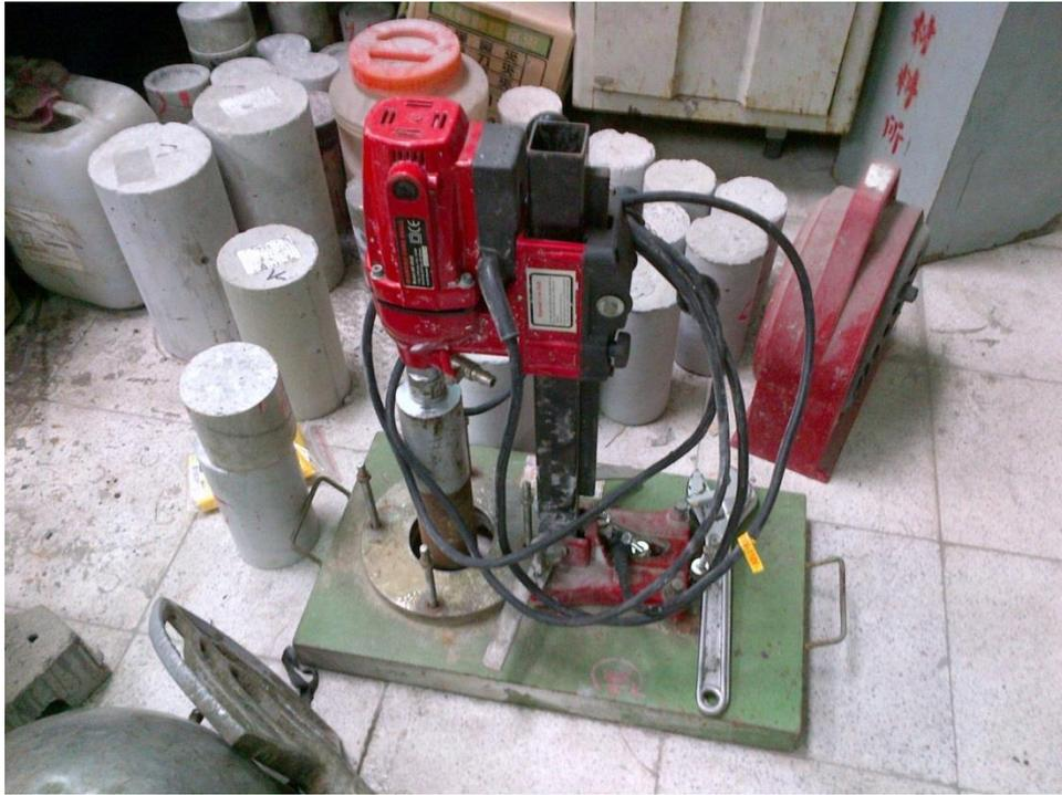
圖 4-4 試體鑽心使用設備
