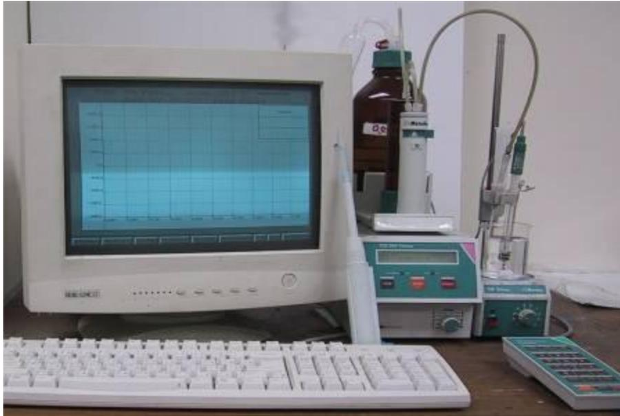
圖 4-3 Metrohm 702 SM 型電位滴定儀
