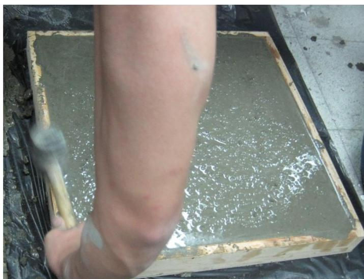
圖 6-15 30 cm\*30 cm\* 10 cm 方型試體製作情形
