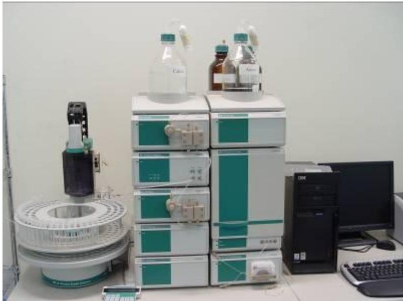
圖 4-6 Metrohm MIC 模組式離子層析儀
