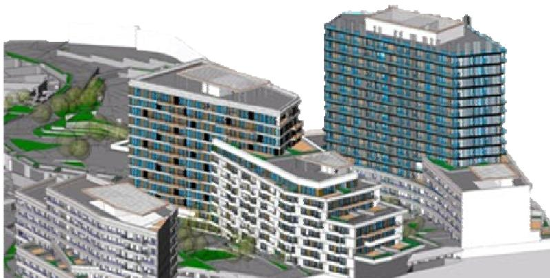
圖 4.3 LOD 300 模型細緻程度示意圖
