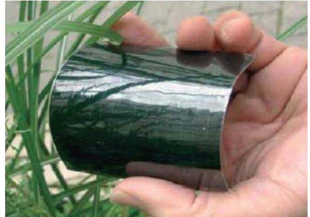
圖 1-2-3-4 非晶矽薄膜太陽電池
