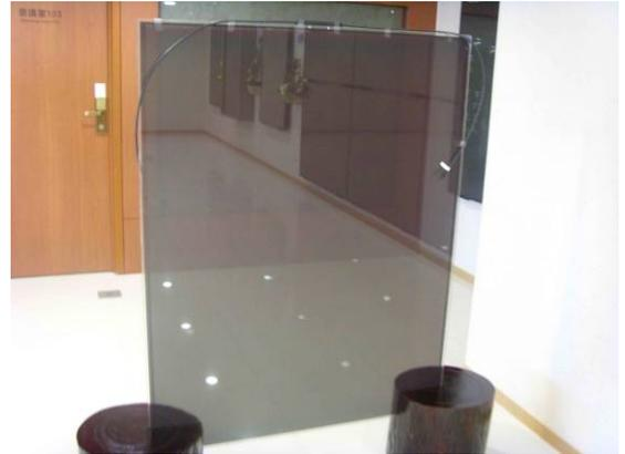
圖 1-2-3-9 非晶矽薄膜 BIPV 之透光性
