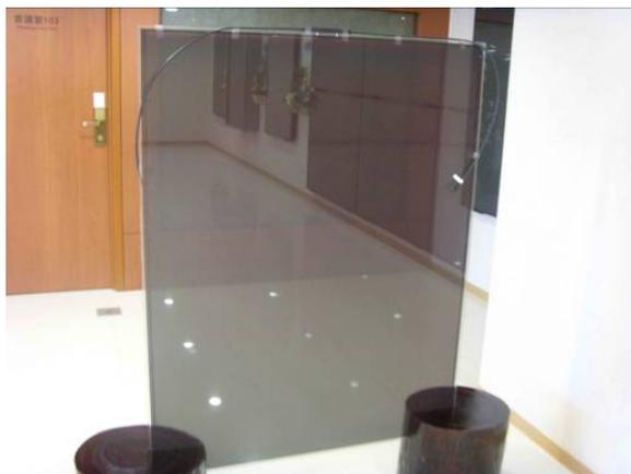
圖 3-2-1 非晶矽薄膜 BIPV 之透光性
