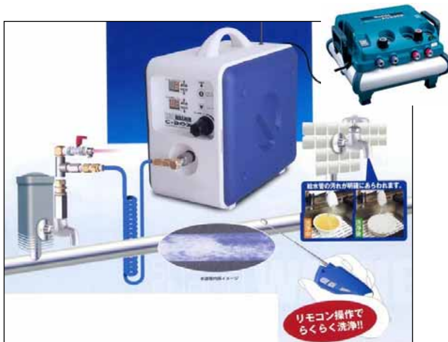
圖 5-1 高週波管路清洗設備施作示意圖
