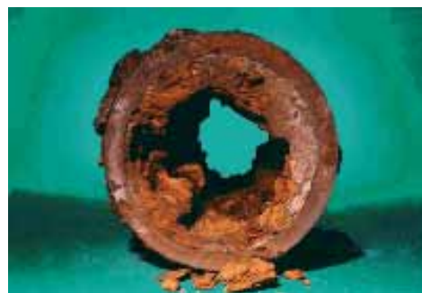
圖5-5 給水管路中鏽蝕與髒污堆積情形
