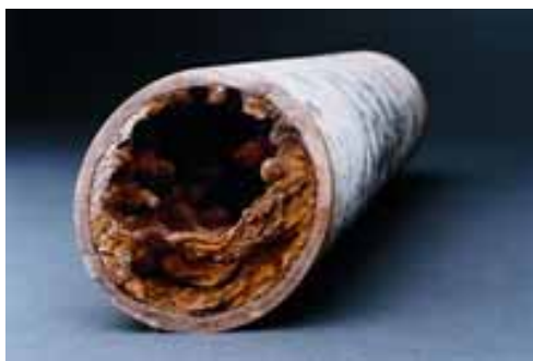
圖5-5 給水管路中鏽蝕與髒污堆積情形
