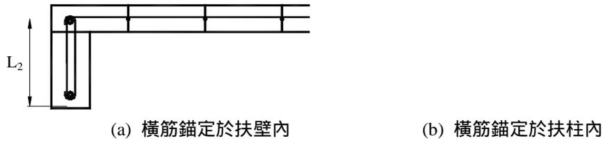
圖 6.11 圍牆端部之橫筋錨定方式
