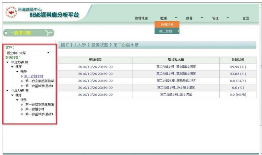
圖8 BEMS節能資料庫系統之設備狀態監測列表功能
