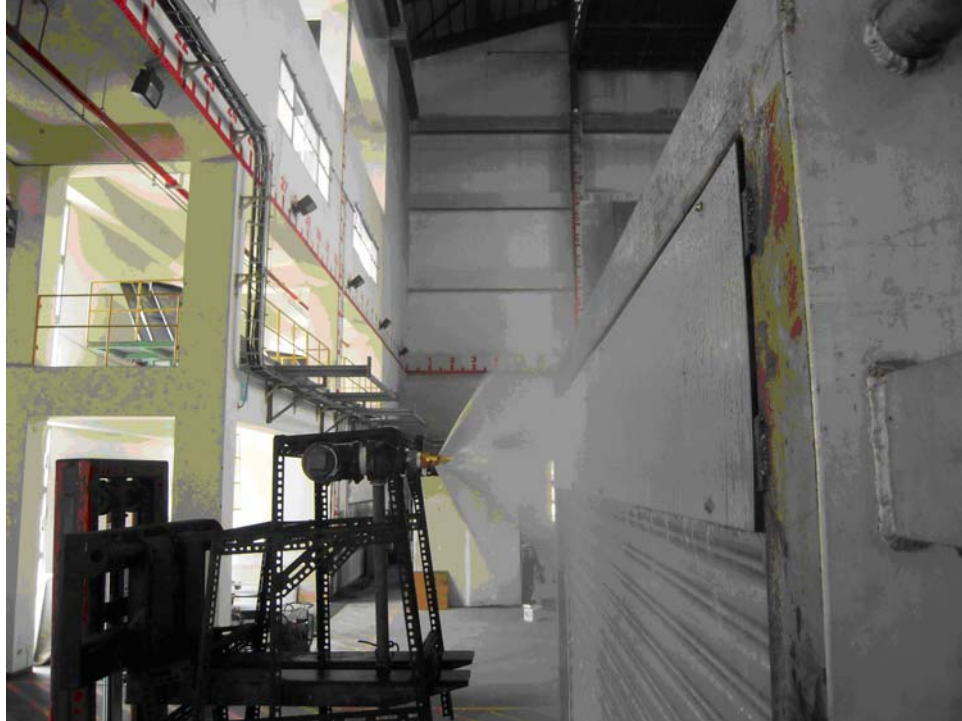
圖3 水霧結合捲門之冷流場試驗
