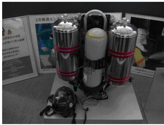
圖4 日本消防研究中心—攜帶式低壓水霧滅火裝置
