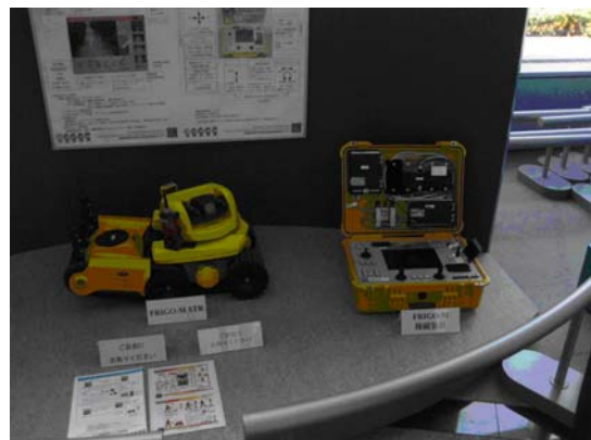
圖2 日本消防研究中心—火災現場遙控偵測設備
