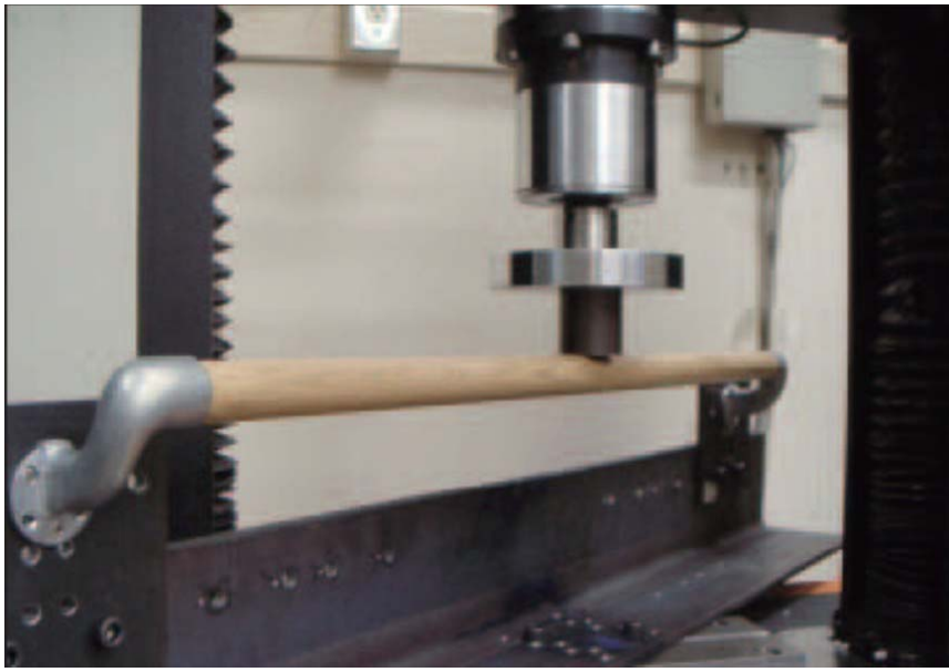
圖1 步行輔助扶手垂直載重試驗
