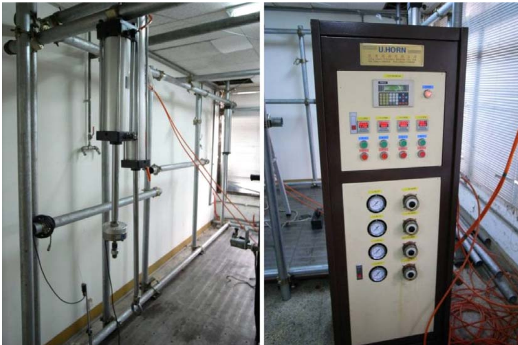
圖2左：鋼管反力構架及加載用氣壓缸 右：氣壓控制器單元(右)
