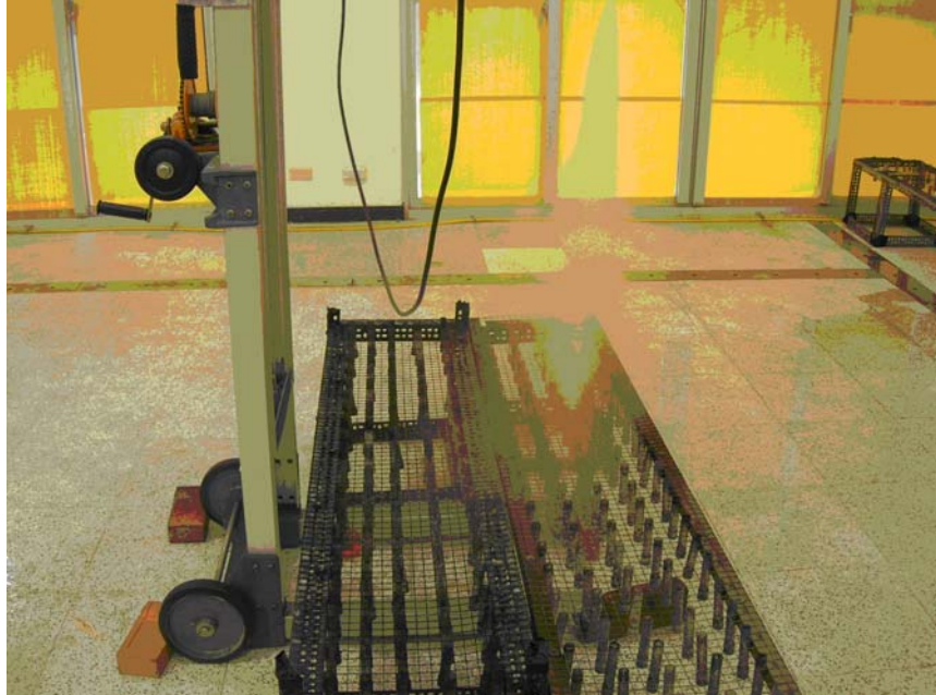
圖5、細水霧撒佈量量測 ( 防火實驗中心 )
