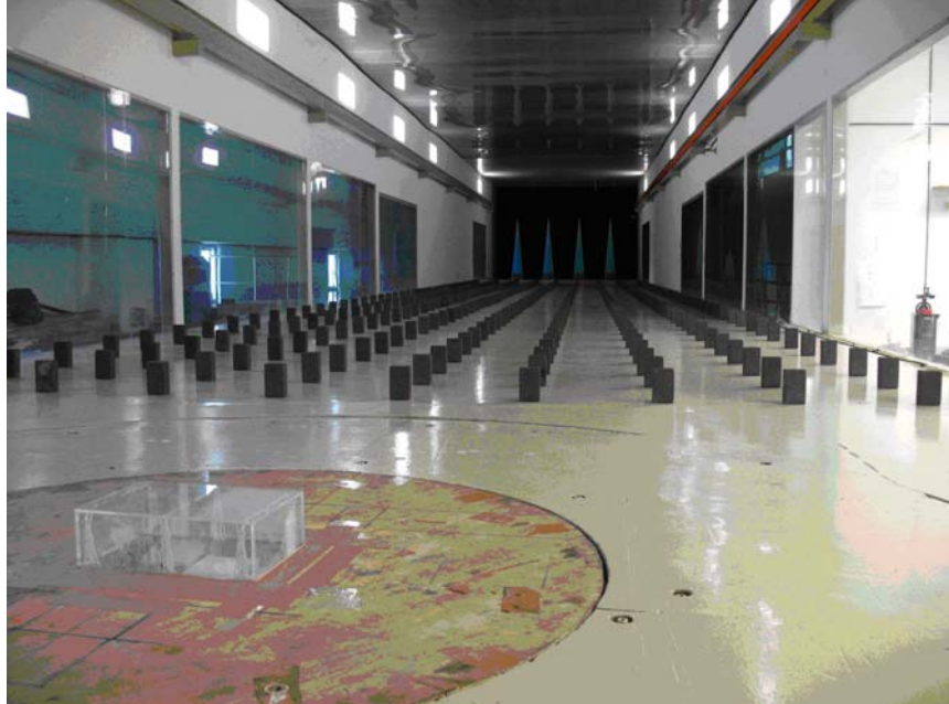
圖一、非封閉式建築模型於風洞中進行實驗量測
