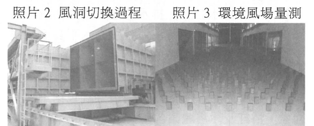
照片 2 風洞切換過程 照片 3 環境風場量測
