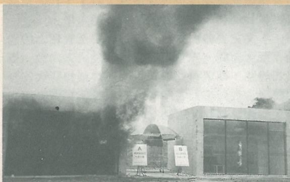
一般材料裝修房間(左)與防火材料裝修房間(右)在起火後3分鐘之情景。
