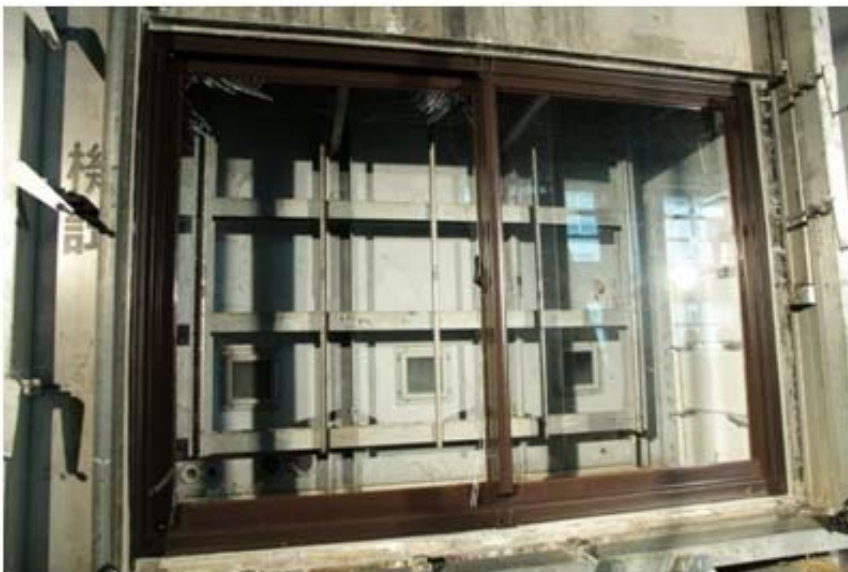
圖4 無貼膠帶原型玻璃破裂情形
