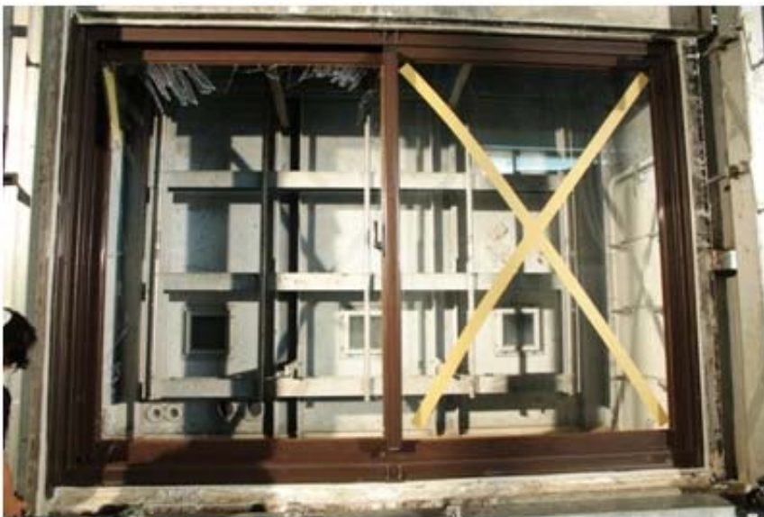
圖6 黏貼X字型膠帶玻璃破裂情形
