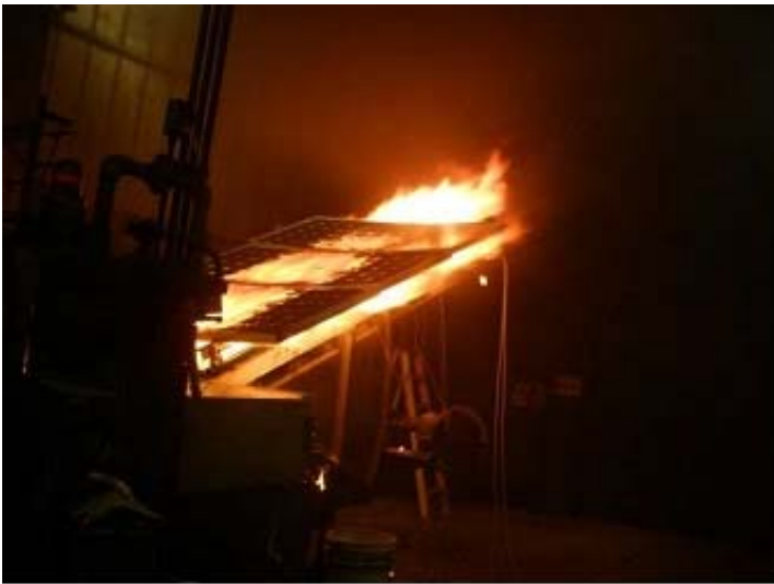
圖4 UL 790光電板系統耐火測試
