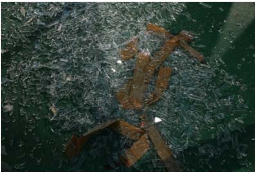
圖7 黏貼X字型膠帶破裂時沾黏情形
