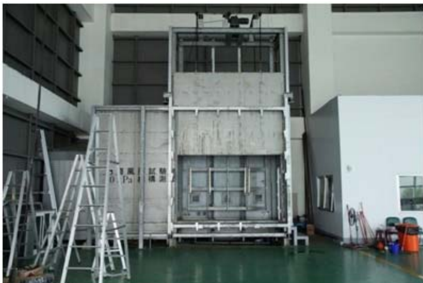
圖1 本所門窗風雨測試艙
