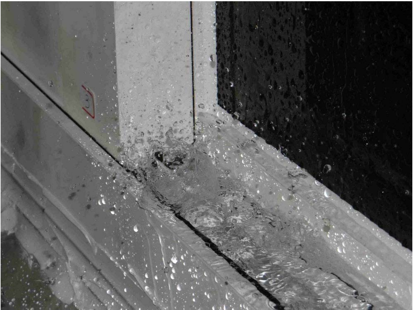
圖1 帷幕牆風雨試驗試體安裝
