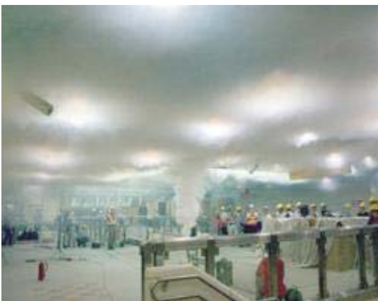
圖2 高雄捷運車站現場以熱煙的方式進行排煙測試
