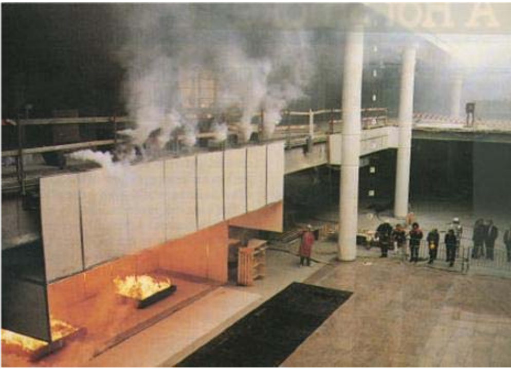
圖3 比利時布魯塞爾機場購物廣場熱煙試驗
