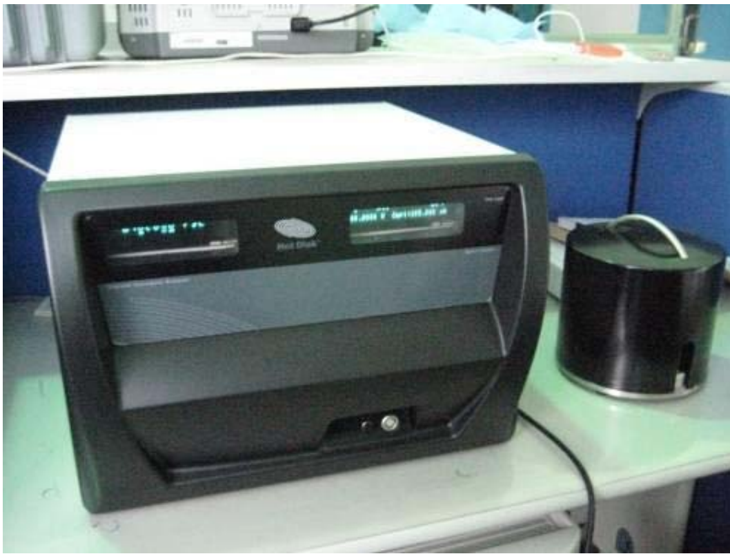
圖3 Hot Disk熱傳導係數量測儀
