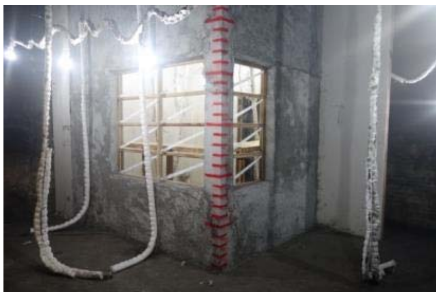
圖2 實尺寸燃燒實驗熱電偶配置圖
