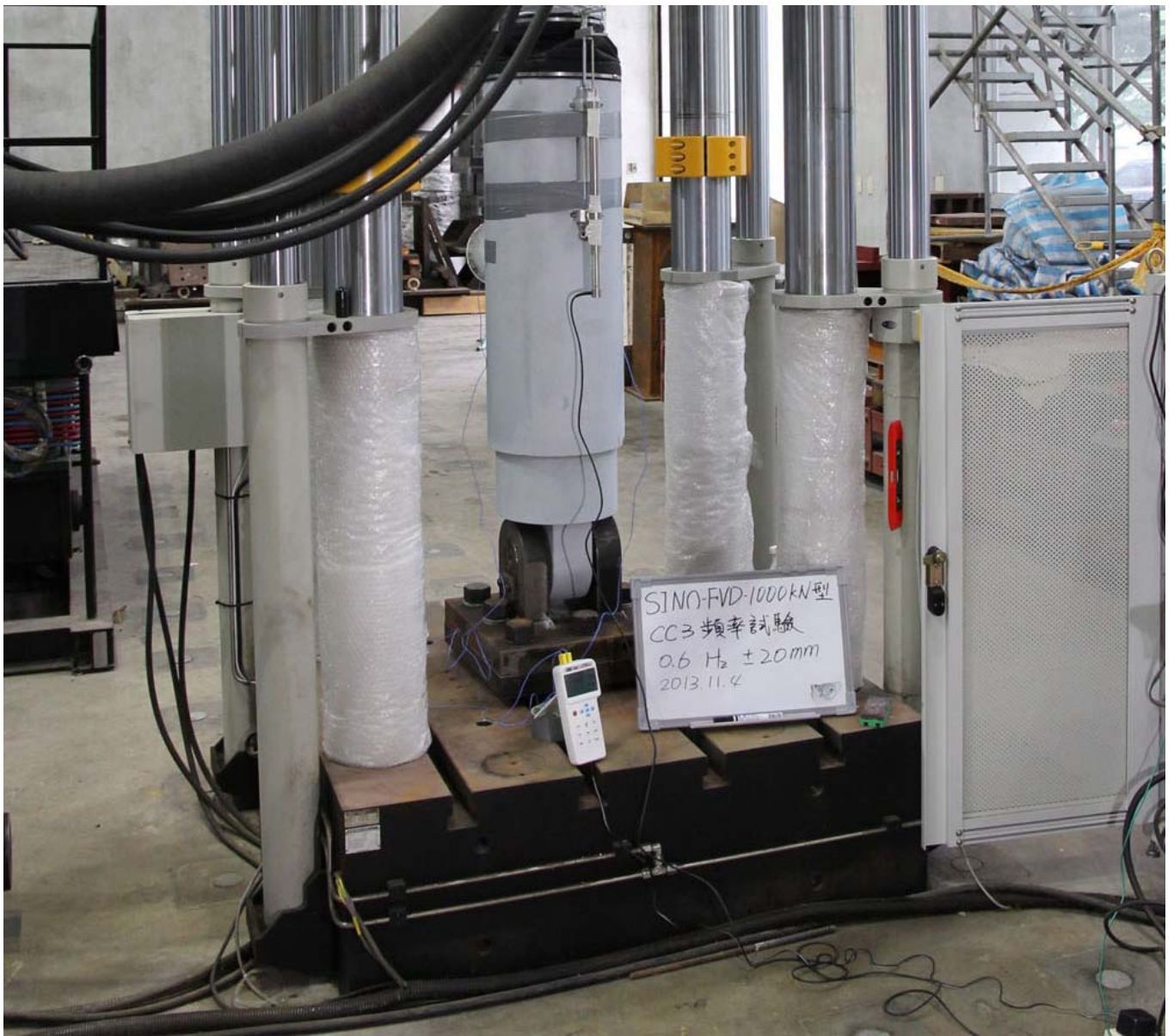
圖1 本所油壓耐震阻尼器檢測服務
