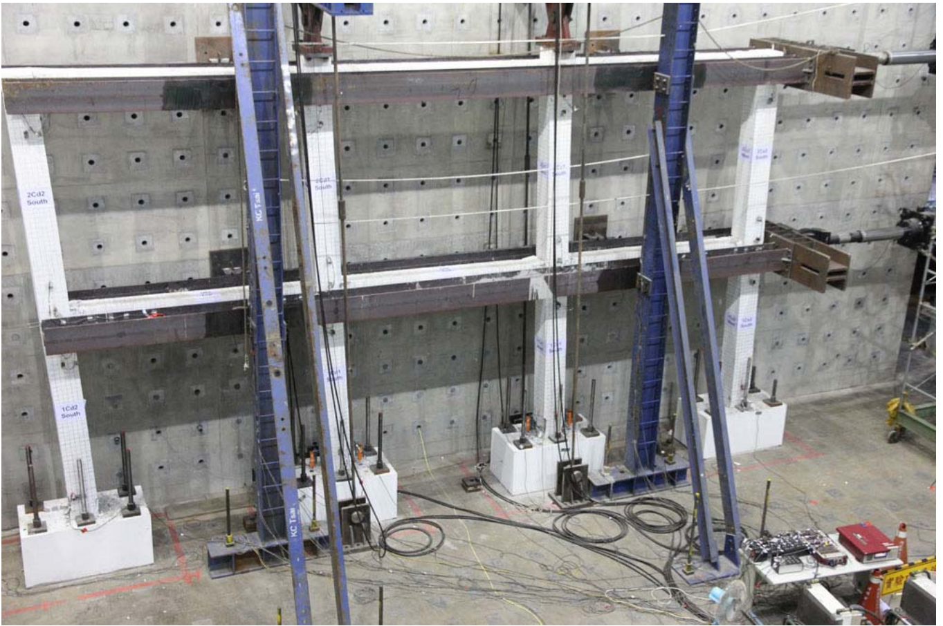
圖2 本所委託研究包覆型SRC柱箍筋耐震設計需求之構架試驗
