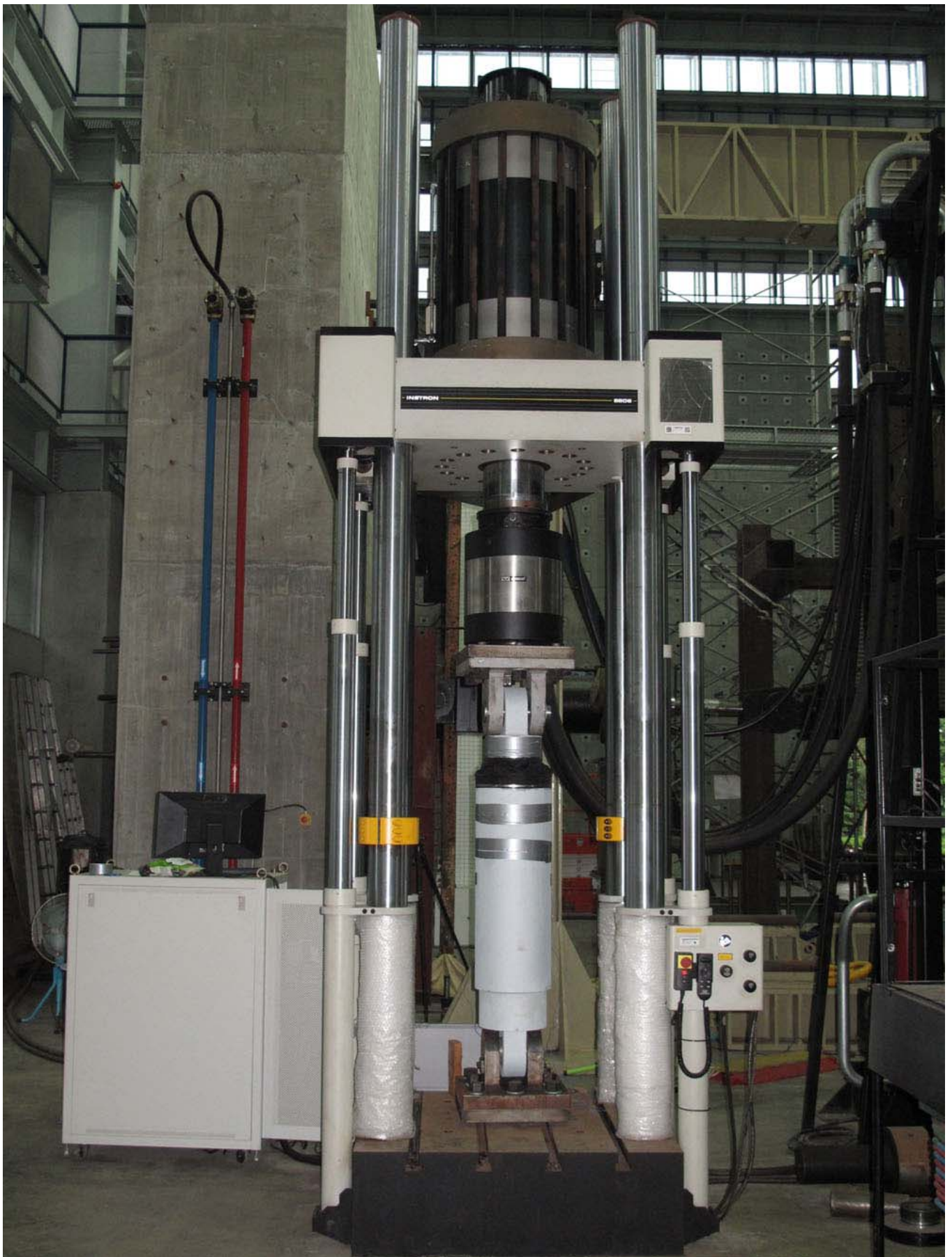
圖1. 250噸動態試驗機阻尼器試驗裝置
