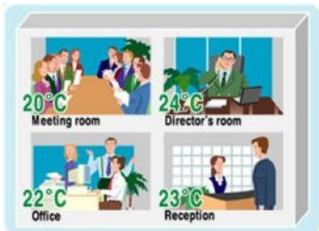
圖 4-2 VRV 系統分區調整室內溫度
