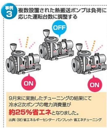
圖 2-2 主機台數控制示節能意圖
