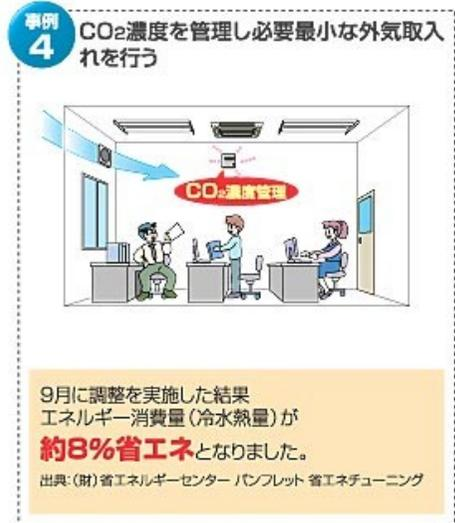
圖 5-1 CO<sub>2</sub> 濃度控制示意圖
