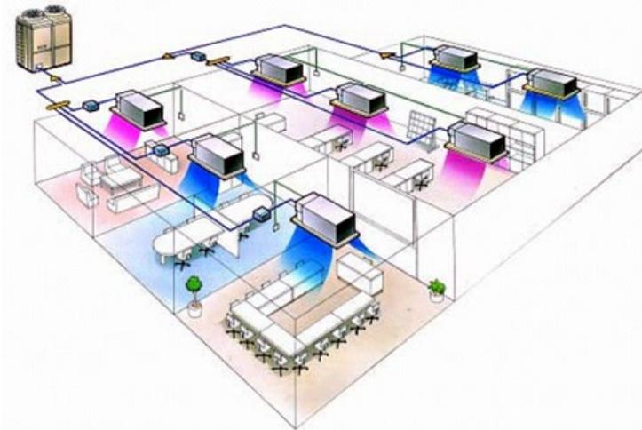
圖 4-1 可變冷媒流量(VRV)空調方式
