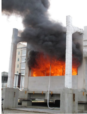
圖12 第1次真實火害實驗照片
