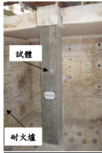
圖4 試體、加載設備與耐火爐裝置
