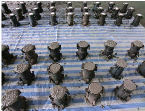
圖 2 混凝土圓柱試體之製作
