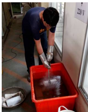
圖 8 圓柱試體強制冷卻方式
