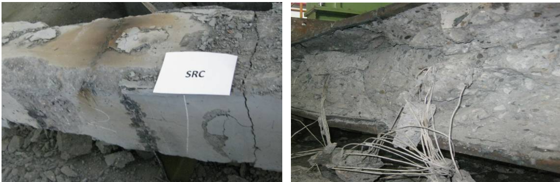
圖 9 試體試驗後內部混凝土情形 (資料來源：本研究拍攝)
