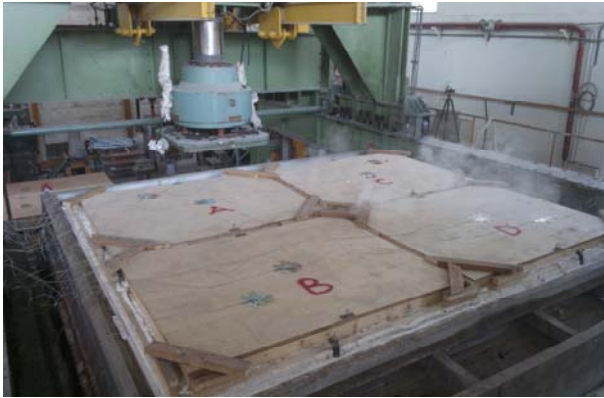
圖 13 第Ⅲ-A、Ⅲ-B、Ⅲ-C、Ⅲ-D 組試體進行加熱實驗中非加熱面
