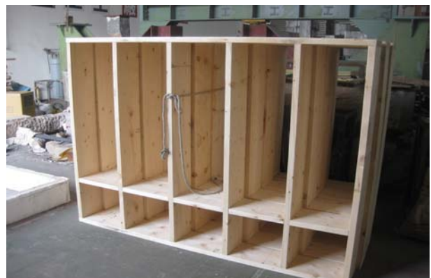
圖 5 第 III-A、III-B、III-C、III-D 組木樓板試體構架完成
