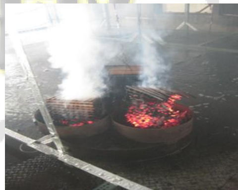
圖 9(a) 情境六 (70% 遮蔽率-撒水頭距地板面 4 公尺高) 撒水頭作動十分鐘之情形 (b) 情境六火源之情形
