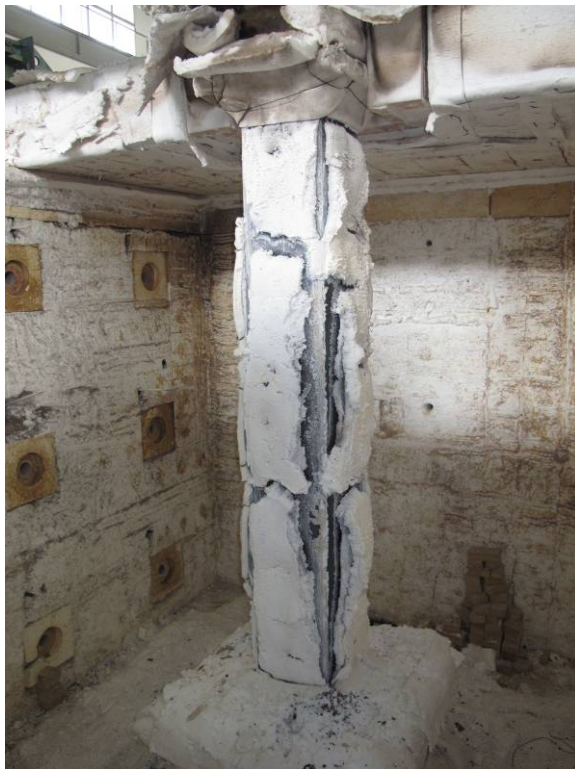
照片2：試體火害後照片
