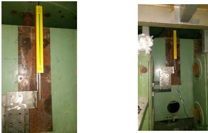
圖 9 軸向變形量測點位置圖
