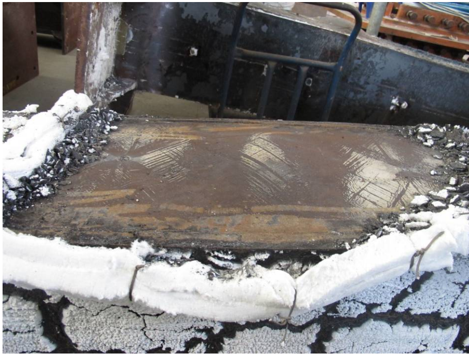
照片3：殘餘極限承載試驗試體破壞照片(1)
