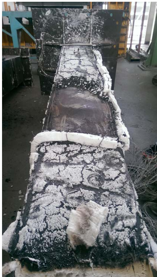
照片4：殘餘極限承載試驗試體破壞照片(2)
