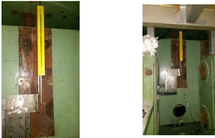
圖 9 軸向變形量測點位置圖
