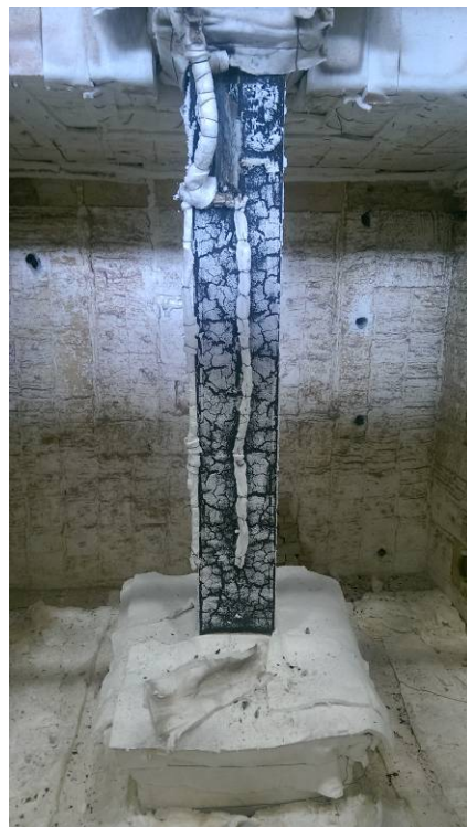
照片2：試體火害後照片
