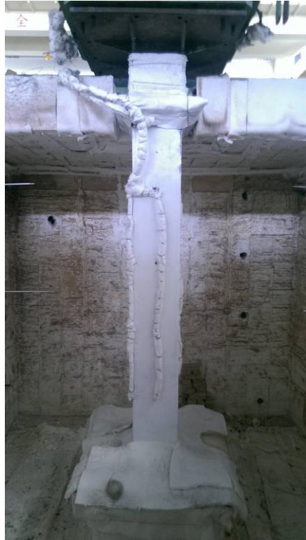
照片1：試體火害後前照片
