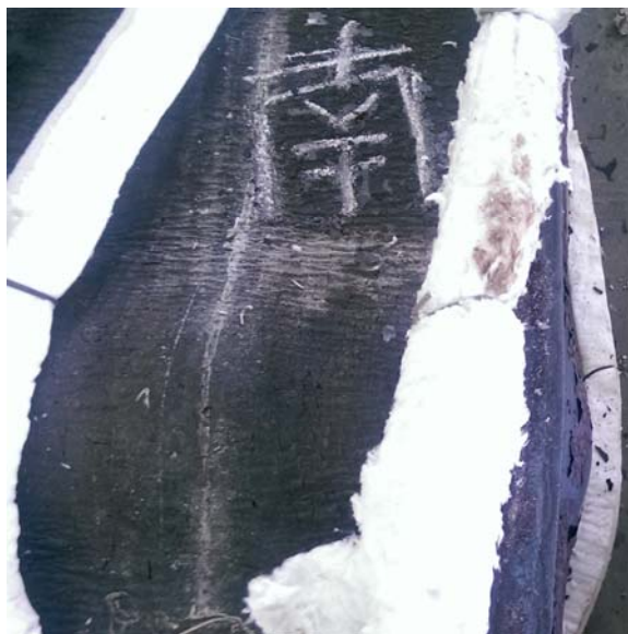
照片3：試驗後試體破壞情況(II)
