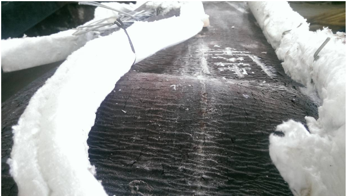
照片2：試驗後試體破壞情況(I)
