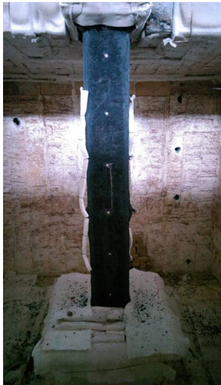
照片2：試驗後試體破壞情況(I)
