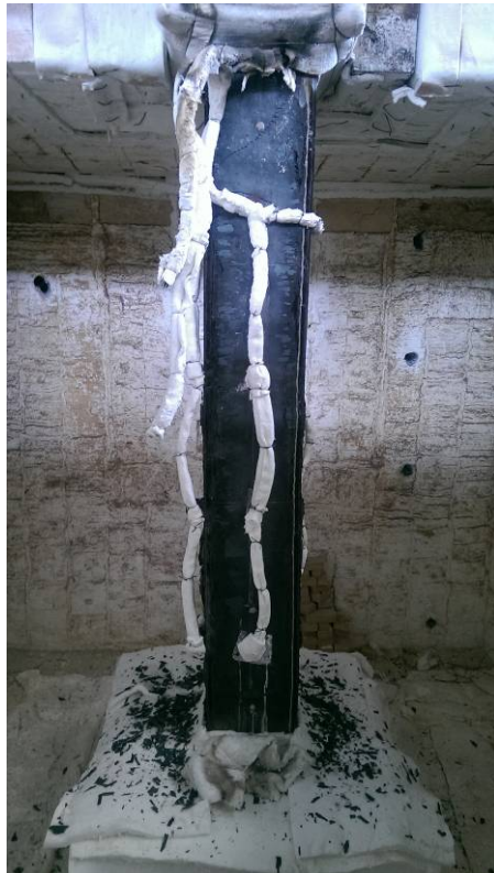
照片2：試驗後試體破壞情況(I)
