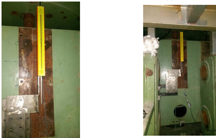
圖 8 軸向變形量測點位置圖
