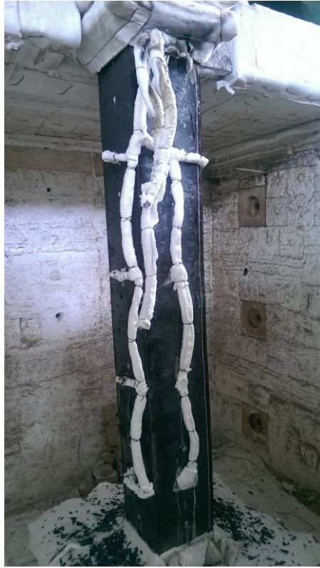
照片3：試驗後試體破壞情況(II)
