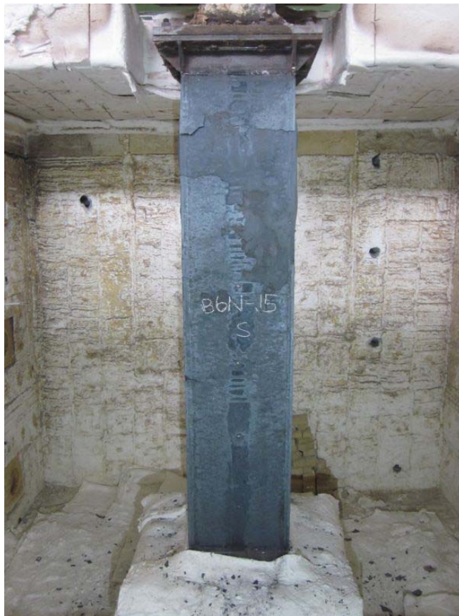
照片4：加載及加熱試驗結束後試體破壞情況
