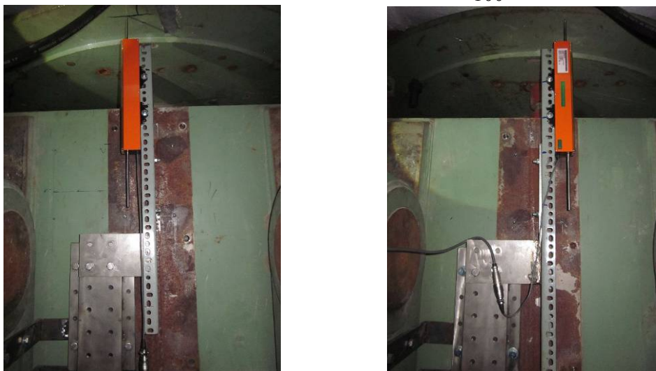
圖 7 軸向變形量測點位置圖
