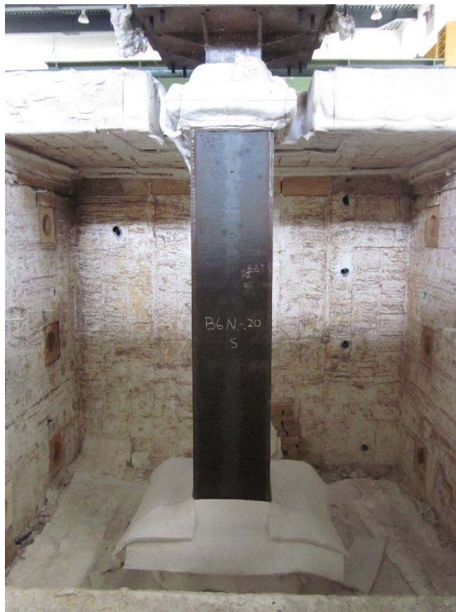
照片2：加載及加熱試驗前試體安裝
