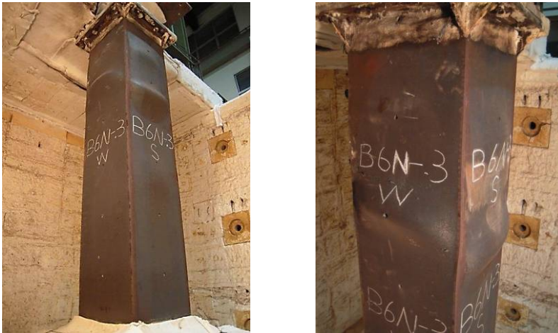
圖 3-4 試體 B6N-3 耐火試驗後之外觀及局部挫屈(資料來源：本研究整理)
