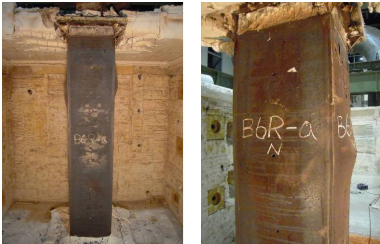
圖 3-9 試體 B6Ra-3 耐火試驗後之外觀及局部挫屈(資料來源：本研究整理)
